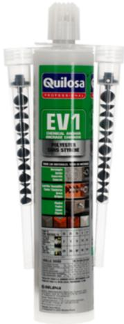
Poliéster sin estireno. El anclaje químico EV1 es un adhesivo bicomponente de curado rápido para fijaciones en soportes de construcción sólidos o materiales huecos, en paredes, columnas, fachadas, suelos, etc. Ideal para cargas medias en aplicaciones no críticas dentro y fuera del edificio. Máxima resistencia en sólo 24 horas
